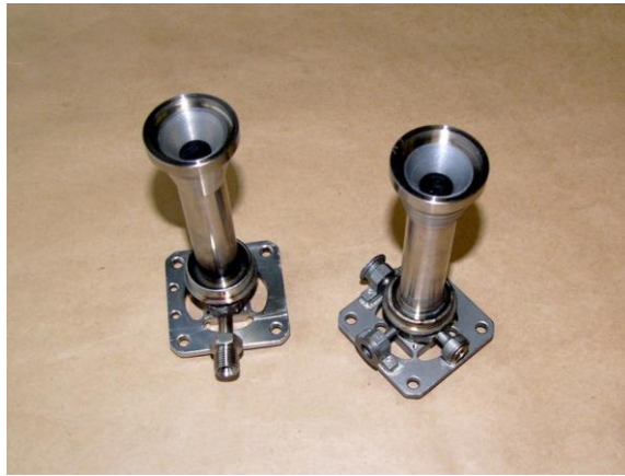
Рисунок 15 - Камеры сгорания из сплава на основе соединения Ni_3Al с приваренным к ней образцами форсуночной головки из стали 12X18H10T
