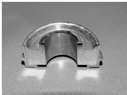
Рисунок 13 - Внешний вид соединения образца из сплава ИНГК-5 со сталью 12Х18Н10Т, полученного аргонодуговой сваркой, х2,5
