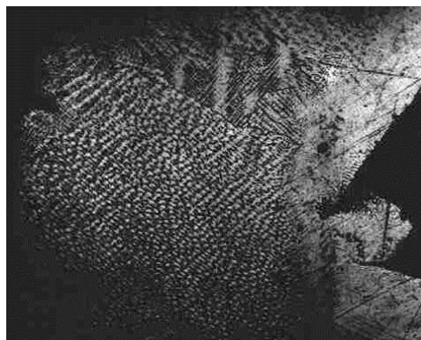
Рисунок 14 - Микроструктура соединения сплава Ni_3Al со сталью 12Х18Н10Т, полученное аргонодуговой сваркой, после термообработки, х 75
